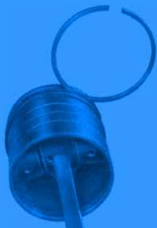
Bild 57. Kolbenringe müssen sich in den Nuten rundum klemmfrei abrollen lassen
