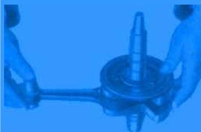
Bild 59. Der Kolbenbolzen darf in dieser Stellung nicht von selber durchsinken, er muß sich aber mit leichtem Fingerdruck durchdrücken lassen
