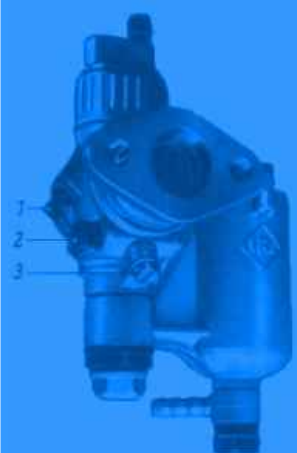
Bild 13. Gasschieberanschlageschraube (1), Leerlauf Luftschraube (2) und Leerlaufdüse (3)
