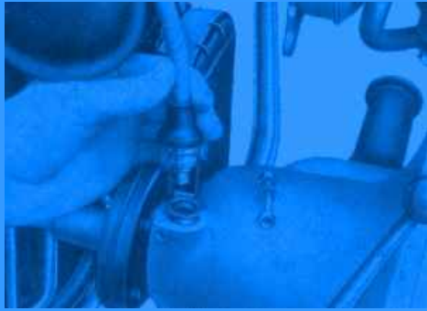
Bild 47. Ausbau der Tachowelle
