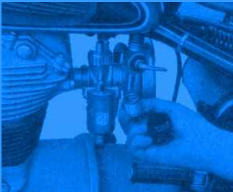
Bild 46. Kraftstofffilter des Benzinahns reinigen
