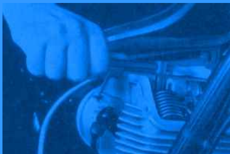
Bild 40. Zuganker für Zylinderkopf nachziehen
