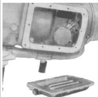
Bild 15. Blick von schräg unten in den Ölvorratsraum
