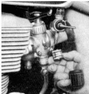
Bild 68. Kraftstofffilter des Benzinahns reinigen
