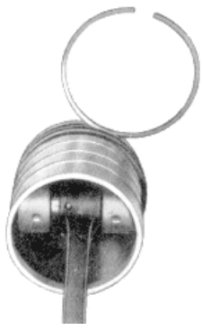
Bild 80. Kolbenringe müssen sich in den Nuten rundum klemmfrei abrollen lassen
